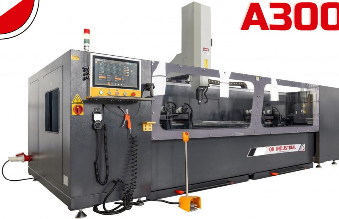
Centro de mecanizado CNC de 4 ejes eléctricos con movimiento mediante servomotor. CNC marca Power Automation (Alemania), con interfaz inteligente y de fácil operación.
