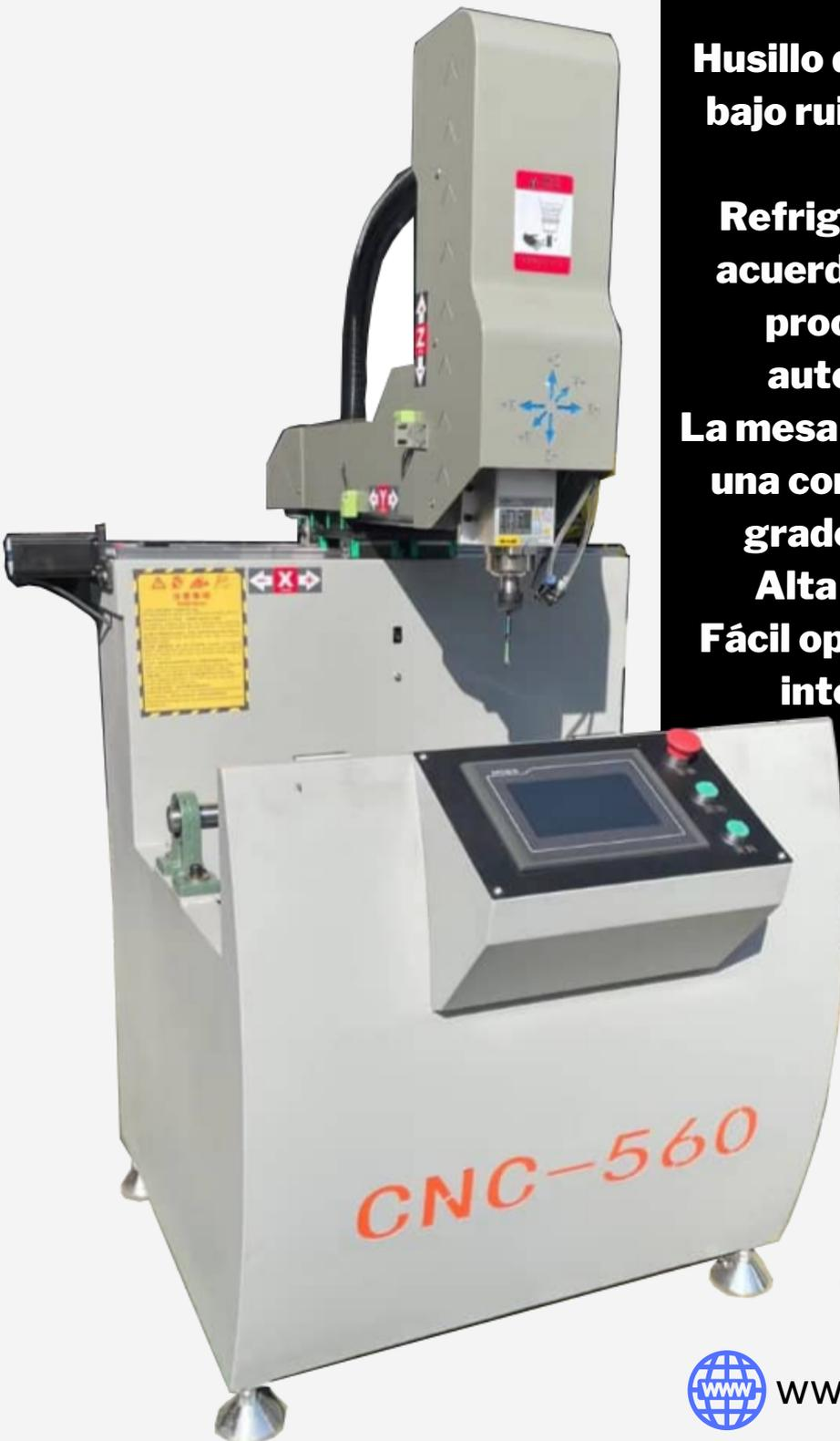
**Aplicable para perforar orificios, fresar ranuras, procesar orificios circulares y orificios de formas especiales, grabado plano de perfiles de aleación de aluminio.**
